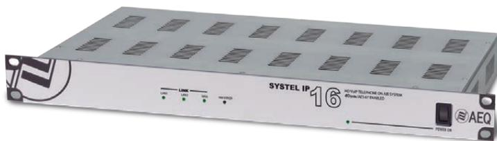
*Systel IP16, de 1 UR para 16 líneas telefónicas IP simultáneas, 4 líneas adicionales para teléfonos IP de operador, 4 entradas/salidas digitales, 2 entradas/salidas analógicas y 32 entradas/salidas IP protocolo Dante, suficiente hasta 4 estudios.*
