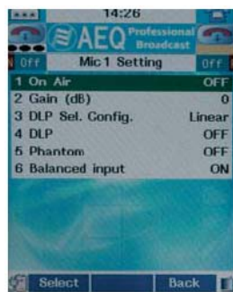
Configuración entrada con DLP y alimentación Phantom disponible.
