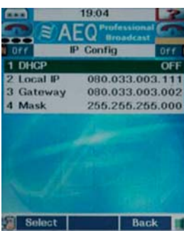
Configuración IP manual o automática DHCP.
